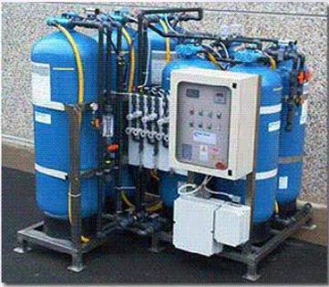
Le resine per impiego civile necessitano di elementi battericidi (Chimici, Celle elettrolitiche, U.V.) per ridurre la carica batterica che si forma nelle suddette resine.
